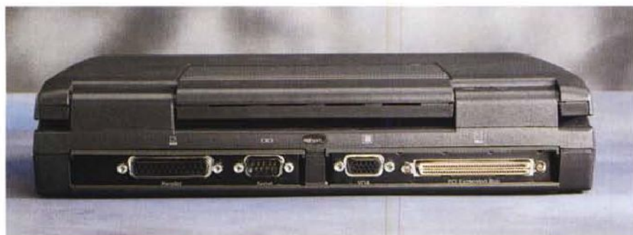
Le varie viste del notebook, dalle quali si possono notare le varie porte di interfaccia, sia come memorie di massa che di I/O audio. Tra le altre spicca la "finestra" dell'interfaccia SIR (ad infrarossi).
